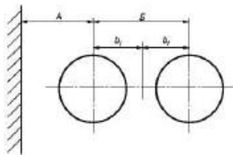
Рисунок 10.1 - Расположение трубопроводов
