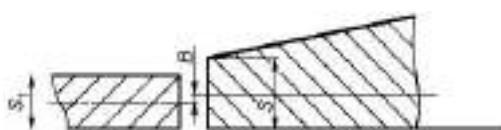
Рисунок 12.2 - Смещение кромок листов в стыковых продольных соединениях
