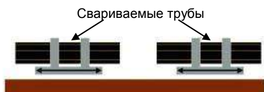
1. Подготовка и центровка труб
